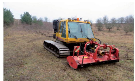
Eine Pistenraupe mit Schlegelmulcher übernimmt das Entfernen kleinerer Gehölze am Hang.
